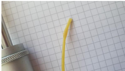
Abb. 9: Unregelmässigkeiten im Filament
