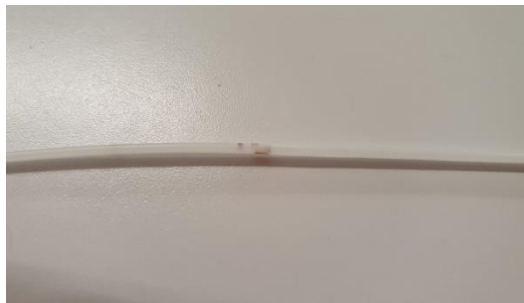
Abb. 11: Verunreinigung im Filament aus PLA-Abfall
