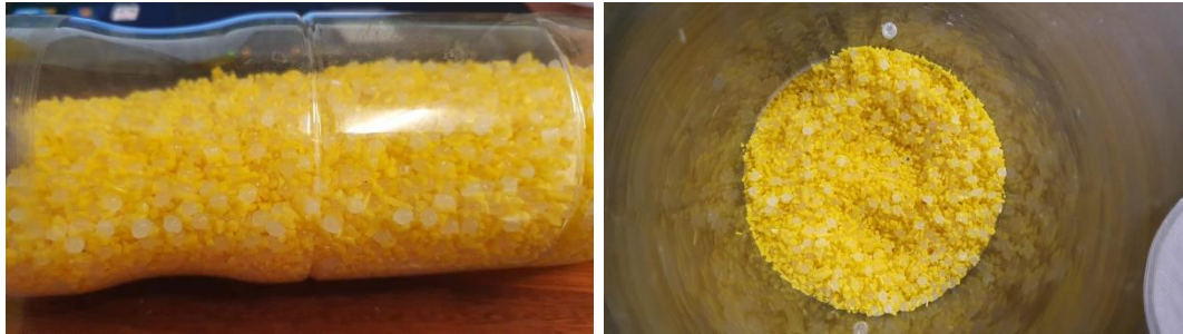
Abb. 5: Mischung aus geshreddertem „Alt-Filament“ und PLA-Pellets
